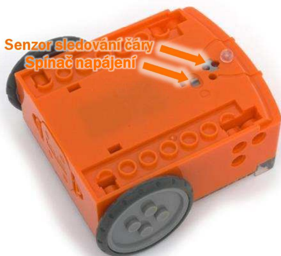
Spínač napájení a senzor čáry na Edisonu
