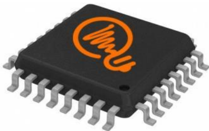
Der Mikrocontroller des Edison
