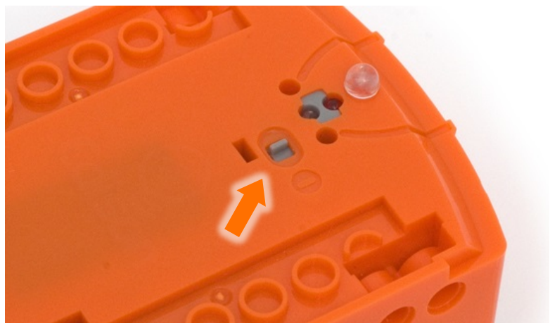
Den Hauptschalter zum Symbol hinschieben
