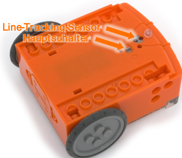
Hauptschalter und Linien-Sensor
